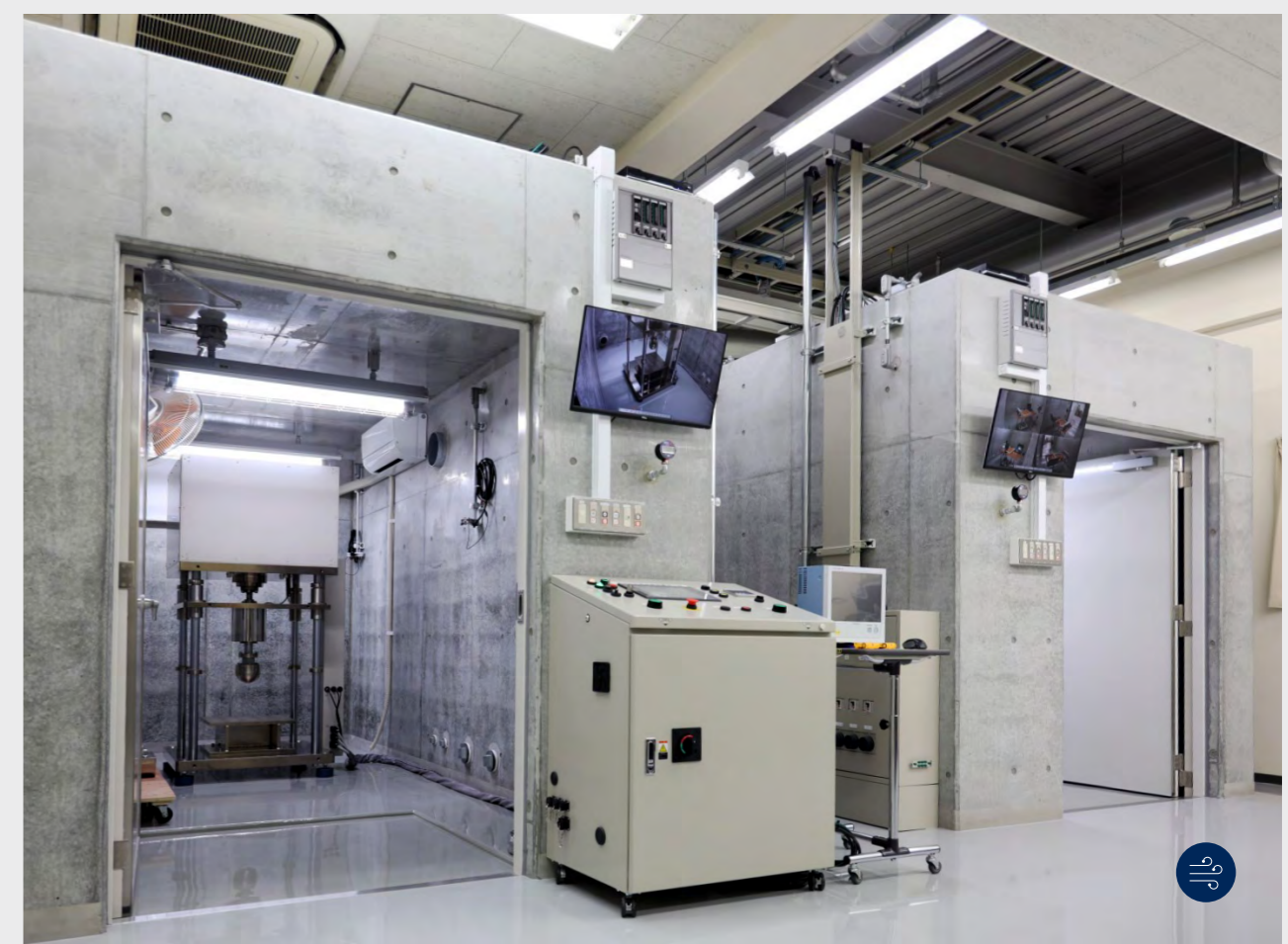
中型防爆槽 (2 基)
